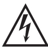
Il flash all'interno del triangolo evidenzia la presenza di una tensione pericolosa non isolata all'interno del prodotto che potrebbe essere di entità sufficiente a generare un rischio di scosse elettriche per le persone.
